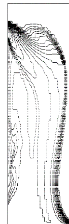
Рис. 5. Верхнее расположения форсунок, массовая доля окислителя.
